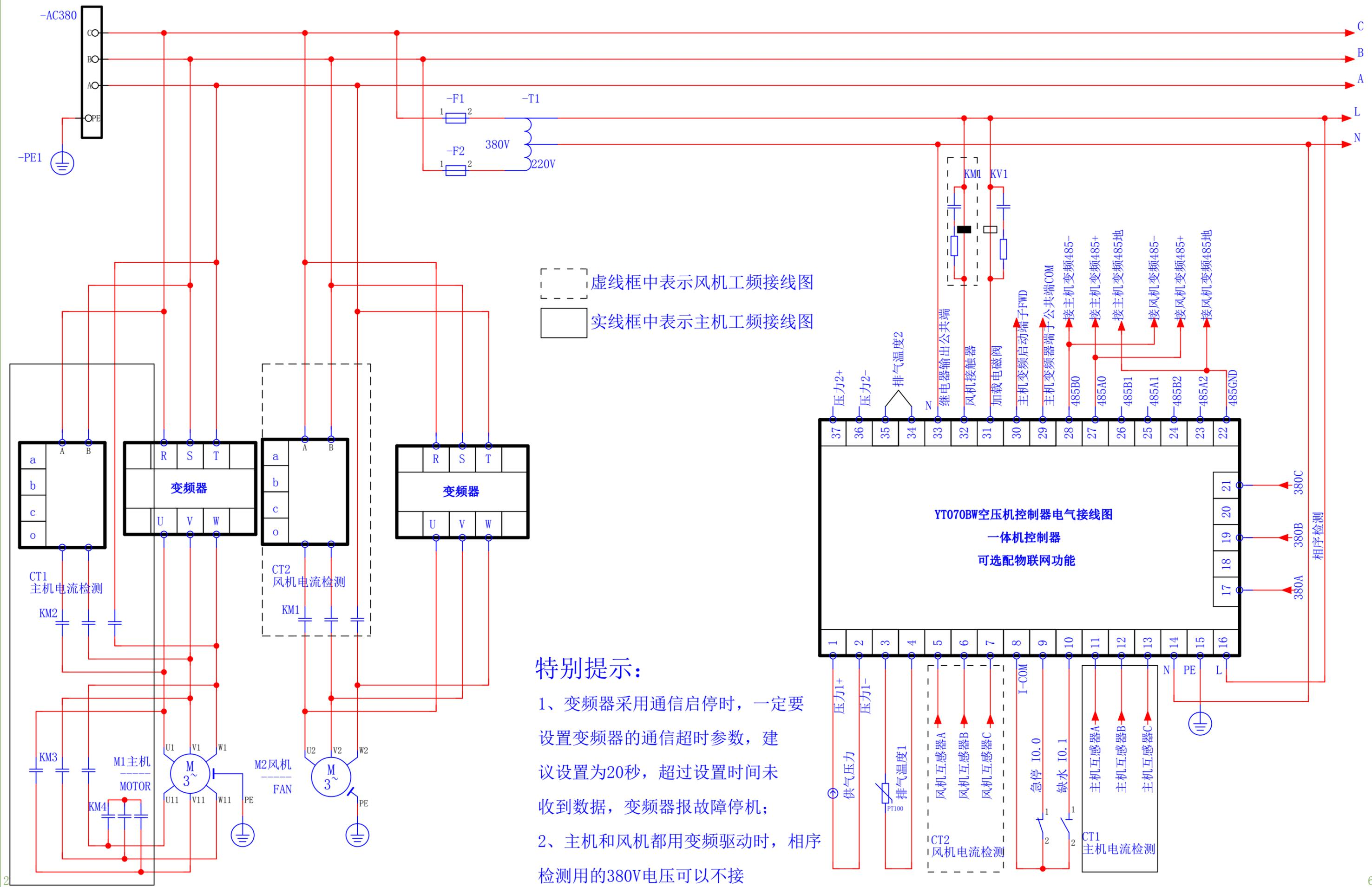
虚线框中表示风机工频接线图
